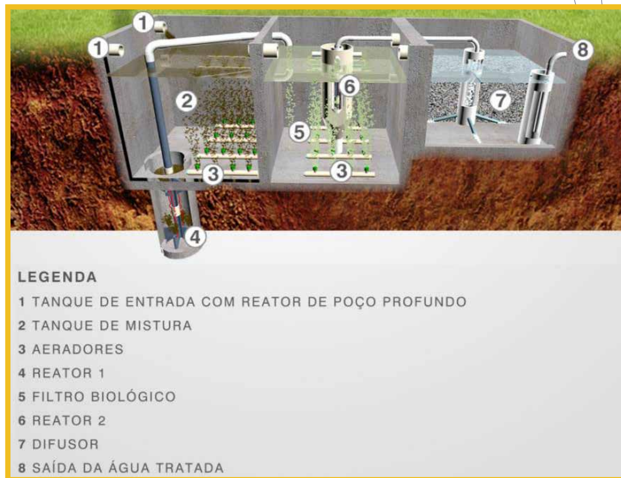
Figura 40. Diagrama básico de funcionamento do sistema coroh®.
